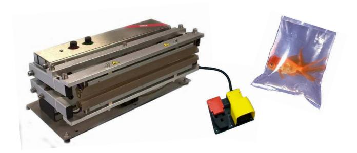
La saldatrice E 35 è indicata per sigillare sacchi di polietilene, PVC, polipropilene di forte spessore, anche con soffietti laterali, e per sacchi in alcuni tipi di accoppiati e coestrusi.
